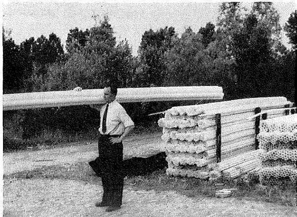
Fig. 7. Polyvinylrørene vejer kun \frac{1}{12} af støbejernsrør.
